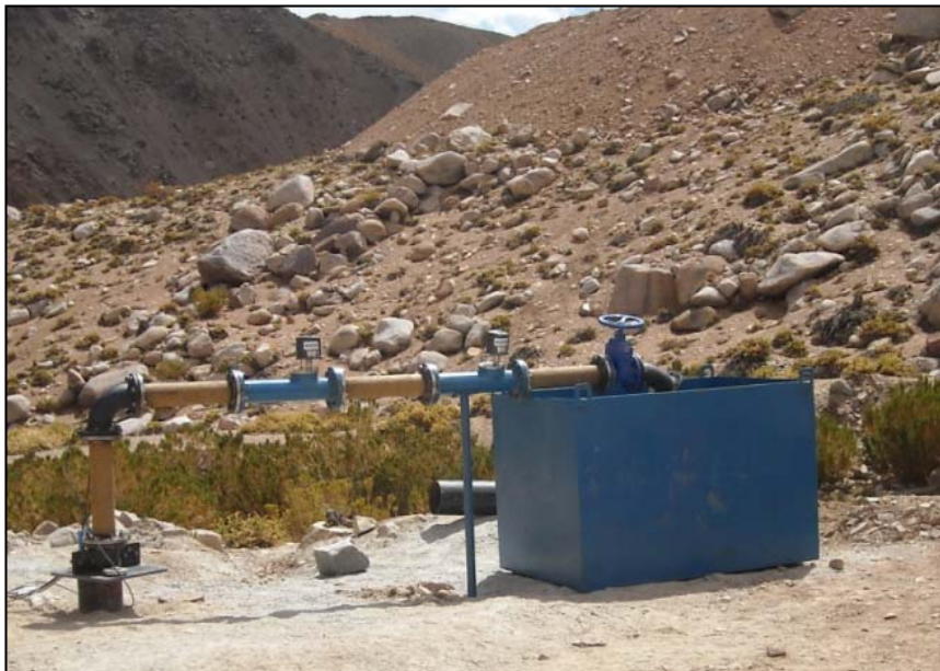
Figura 4-3 Equipo de bombeo instalado durante bombeo constante de pozo PBC-01.
